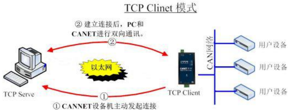
图 4.2 TCP Client 模式通讯示意图
