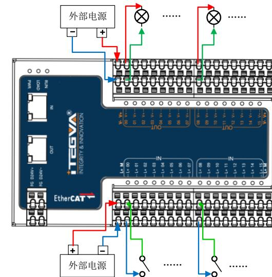
注意: 输出信号的最大驱动电流为 500mA, 使用前请查看外部负载额定功率、内阻等情况, 如果负载所需电流超过 500mA, 请酌情增加限流措施。
