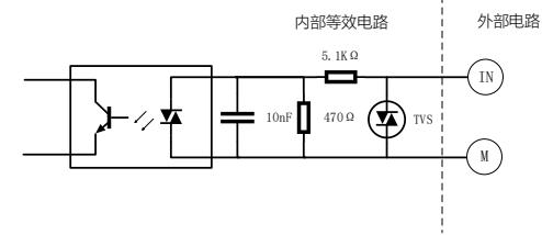
上图中 M 为外部输入信号的公共端, IN 为外部输入信号。
